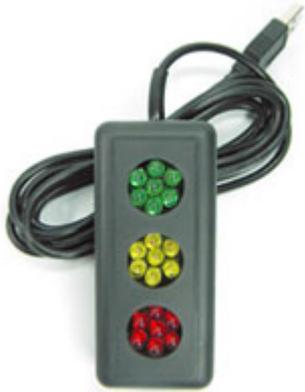
Die Backup-Ampel ist eine einfache und sehr gut erkennbare Signaleinrichtung, die von Z-DBackup gesteuert werden kann. Sie besteht aus drei Leuchtflächen in Rot, Gelb und Grün. Die Leuchtflächen sind aus sieben superhellen LEDs mit einer Leuchtkraft von jeweils ca. 200 mcd und einem Abstrahlwinkel von 30° zusammengesetzt.
